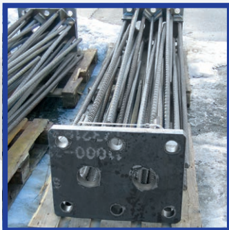
Placă de bază comună pentru stâlpi cu secțiune transversală mică și solicitări ridicate.
