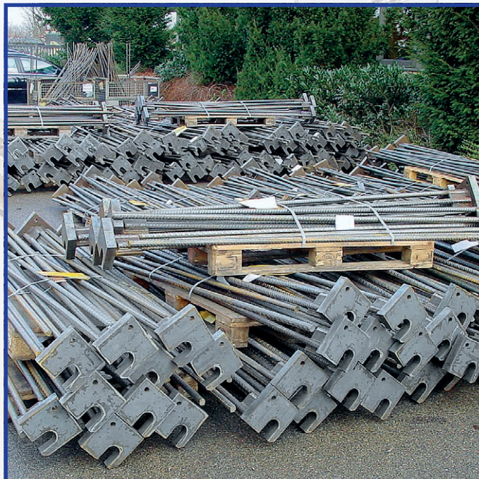
Saboți metalici utilizați la prinderea grinzilor prefabricate
