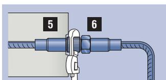
**5** Cupla trebuie înșurubată cu o cheie dinamometrică, la fel cum se face și în cazul barei de îmbinare normale.
