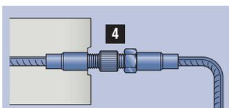
**4** Cupla cu bara de îmbinare și cu mufă (filet dreapta) aduceți la același nivel cu bara cu mufă betonată și cu ajutorul cheii înșurubați în direcția opusă a acelor de ceasornic. Partea îngroșată este localizată mai întâi pe mufa filetelui de stânga (betonat). Dacă acest lucru nu a fost îndeplinit, apoi în al treilea caz ar trebui să fie înșurubat mai adânc sau o piuliță de blocare să fie deșurubată.
