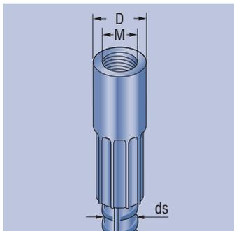
Indiferent de tipul ancorării (cu sau fără compensare) se pot utiliza dispozitivele de fixare fără elemente suplimentare. Și în această situație economisim spațiul în secțiunea transversală a barelor îmbinate folosind barele cu mufă de reducere
