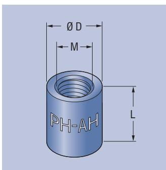
Manșoanele PFEIFER care pot fi sudate sunt utilizate în zonele de construcții în care combinăm construcția de oțel cu beton armat. Printr-un proces simplu de sudare a manșonului și înșurubarea barei obținem conexiunea dintre oțel și beton. Grosimea necesară a sudurii trebuie să fie desemnată de inginerul proiectant în conformitate cu DIN 18800.
