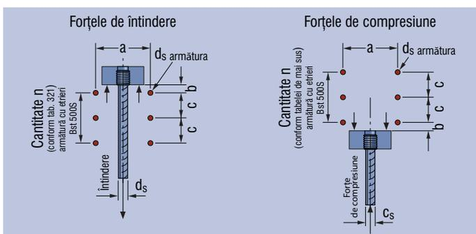
După înșurubarea plăcuței de ancorare în bara de îmbinare, în conformitate cu normele din aprobare, se poate instala în secțiunea betonului. Ar trebui verificată ancorarea conform
