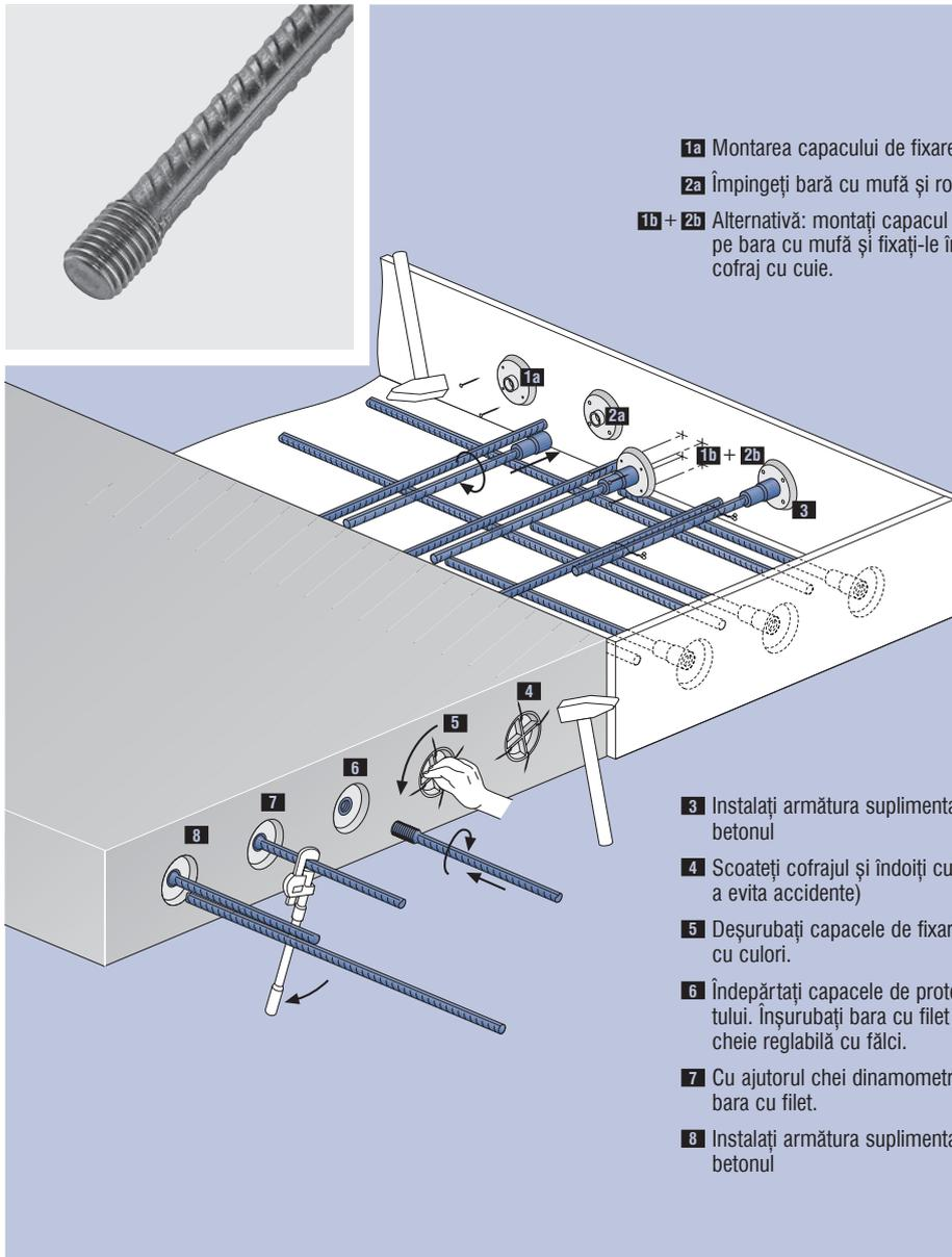
**3** Instalați armătura suplimentară și turnați betonul
