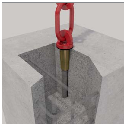
Ancoră filetată PFEIFER înglobată în stâlp
