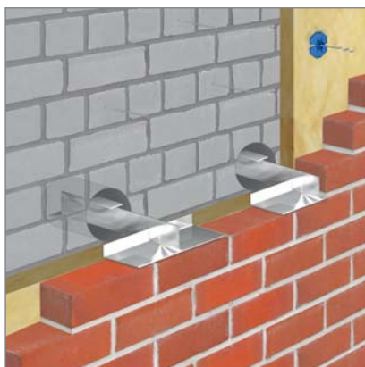
Izolație termică eficientă – un avantaj al unui perete cu trei straturi
