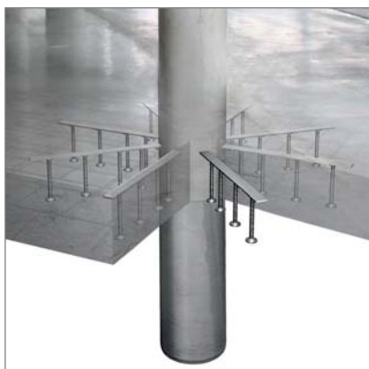
Poziționare armăturilor în jurul stâlpului
